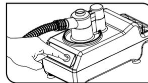
5) Ligue o aparelho na botão “Liga / Desliga” e ajuste a intensidade de névoa desejada.
