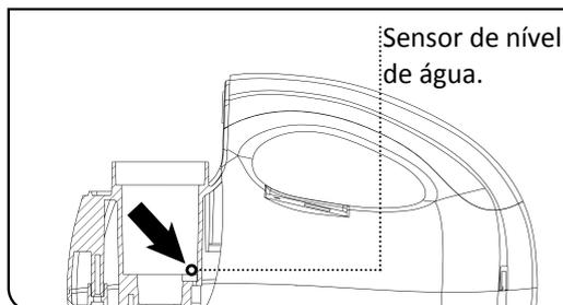
**! \*O sensor de nível de água, proporciona maior segurança ao aparelho, pois evita com que o aparelho seja utilizado de forma incorreta. Certifique-se que o sensor de nível de água está totalmente submerso em água, para o seu funcionamento.**
