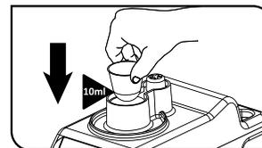
3) Coloque o copo com a solução a ser inalada, não ultrapassando o limite máximo de 10 mL por inalação. (Verifique se não há dois copos para solução encaixados juntos);
