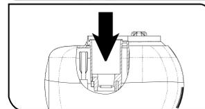
2) Coloque água filtrada ou fervida (Fria) até atingir a marcação em vermelho e cobrir o sensor de nível d'água na parte interna do reservatório.
