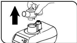
1) Retire a tampa do reservatório e o copo para solução;
